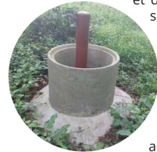
SMBAA va procéder à l'installation de 12 nouveaux piézomètres qui seront répartis sur tout le bassin versant (8 en Maine-et-Loire et 4 en Indre-et-Loire). Ils seront implantés dans des formations géologiques différentes et permettront de suivre l'évolution des niveaux des nappes souterraines. Cette action a débuté en novembre 2023 et s'achèvera en 2024.
