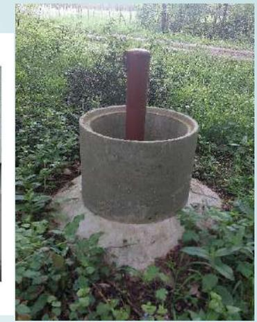
Exemple de piézomètre à réaliser
