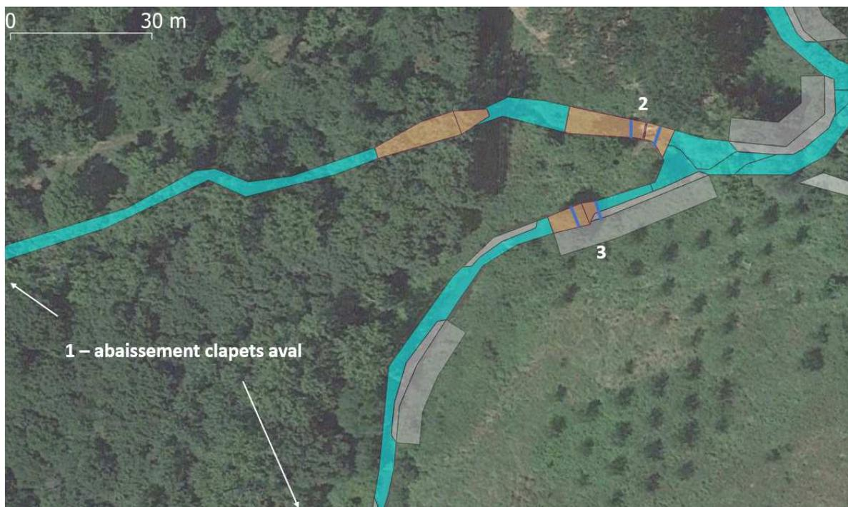
Figure 51 : étapes pour la maîtrise des eaux lors de la mise en place des éléments de génie civil des ouvrages de répartition des débits du bras du Loroux et du Pont Neuf
