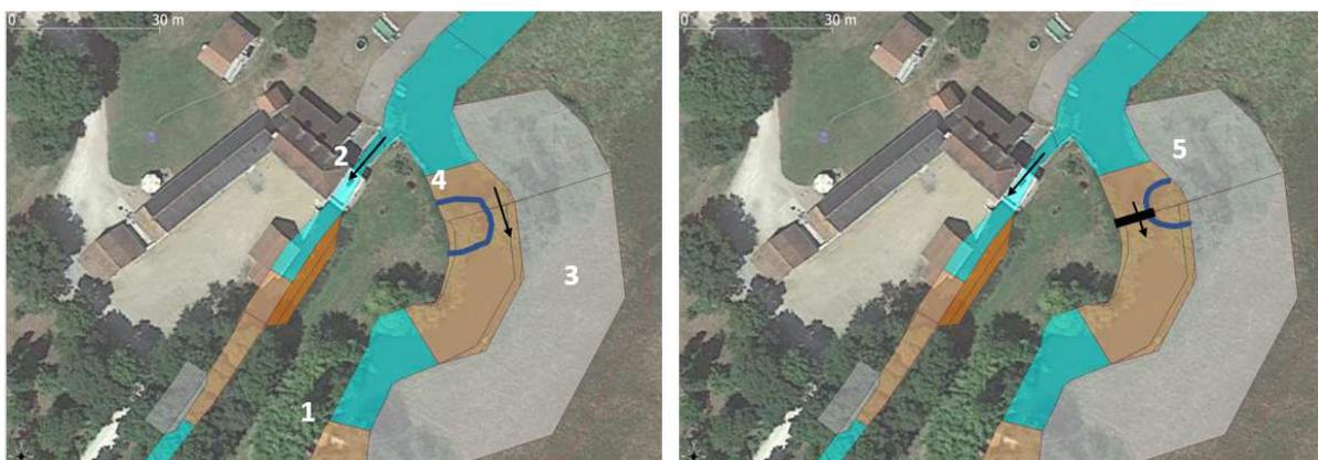
**Figure 50 : étapes pour la maîtrise des eaux lors de la mise en place des enrochements bétonnés du radier de répartition des débits de moulin Chanteloup (radier R03).**
