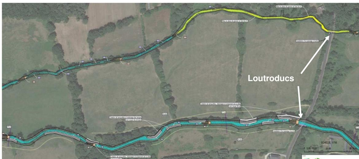
**Figure 21 : extrait de la vue en plan des aménagements prévus sur le secteur Moulin Foulon (plan n°8)**
