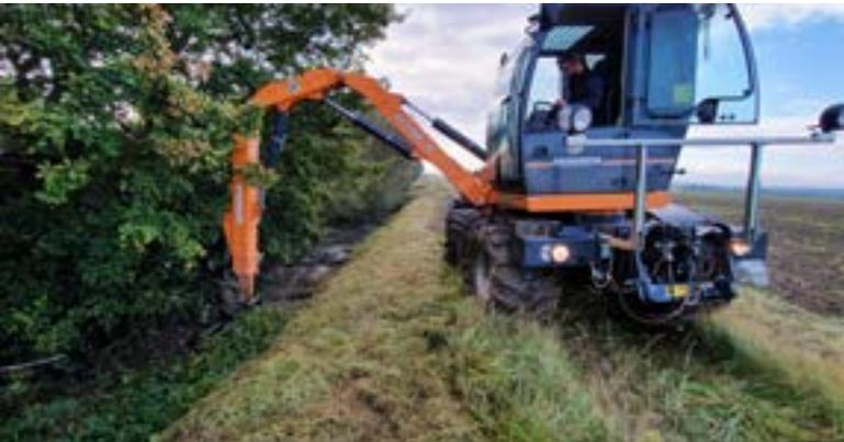
Afin de pouvoir enlever la jussie sur des cours d'eau où elle s'est développée trop densément pour faire un arrachage manuel, le SMBAA s'est équipé d'un godet. Le développement de la jussie sur certains cours d'eau utilisés pour l'irrigation doit être traité au risque de voir l'adduction en eau diminuer.
