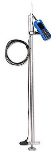
Figure 3 : Jaugeage du Bras du Perray (affluents du Lathan, UG 7) et courantomètre (source : SAGE)
