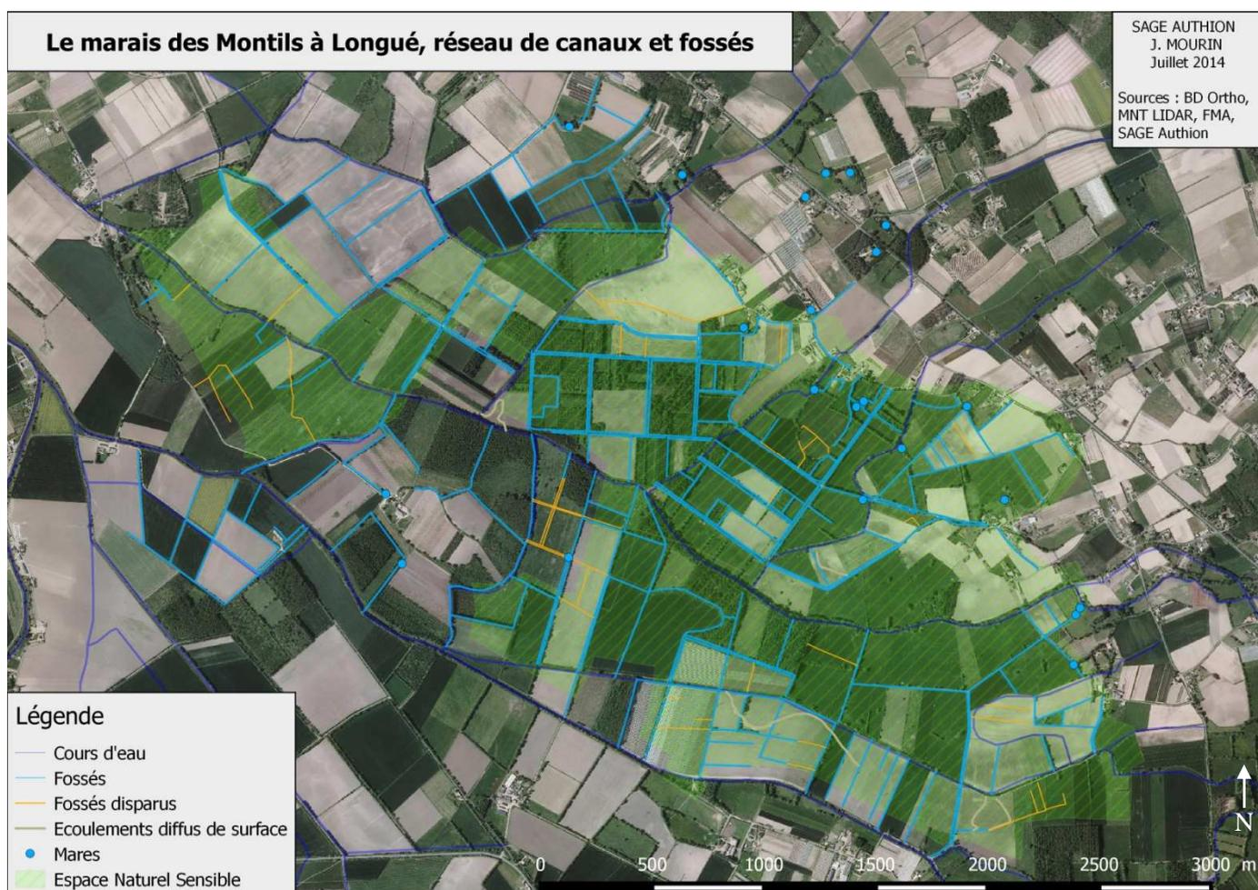
Figure c10 : Cartographie du réseau de fossés dans l'ENS du marais des Montils à Longué
